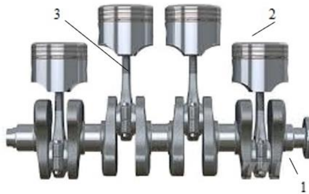
Hình 5.2. Cơ cấu trục khuỷu thanh truyền
